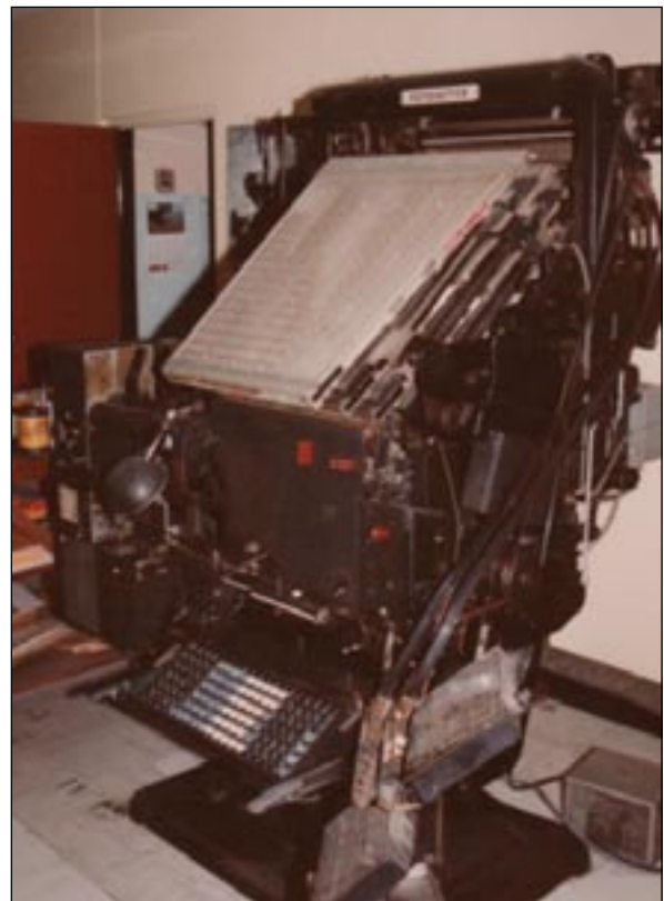
Fotosetter , az első optikai elven működő fényszedőgép
