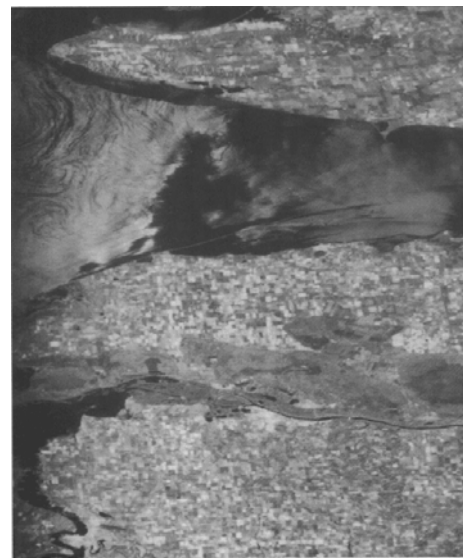
2.6 ábra: A fókuszálás hatása. A nyers (pixelméret: 5km*14km) és a fókuszált (pixelméret:25m*25m) radarkép (Massonet and Feigl, 1998)
