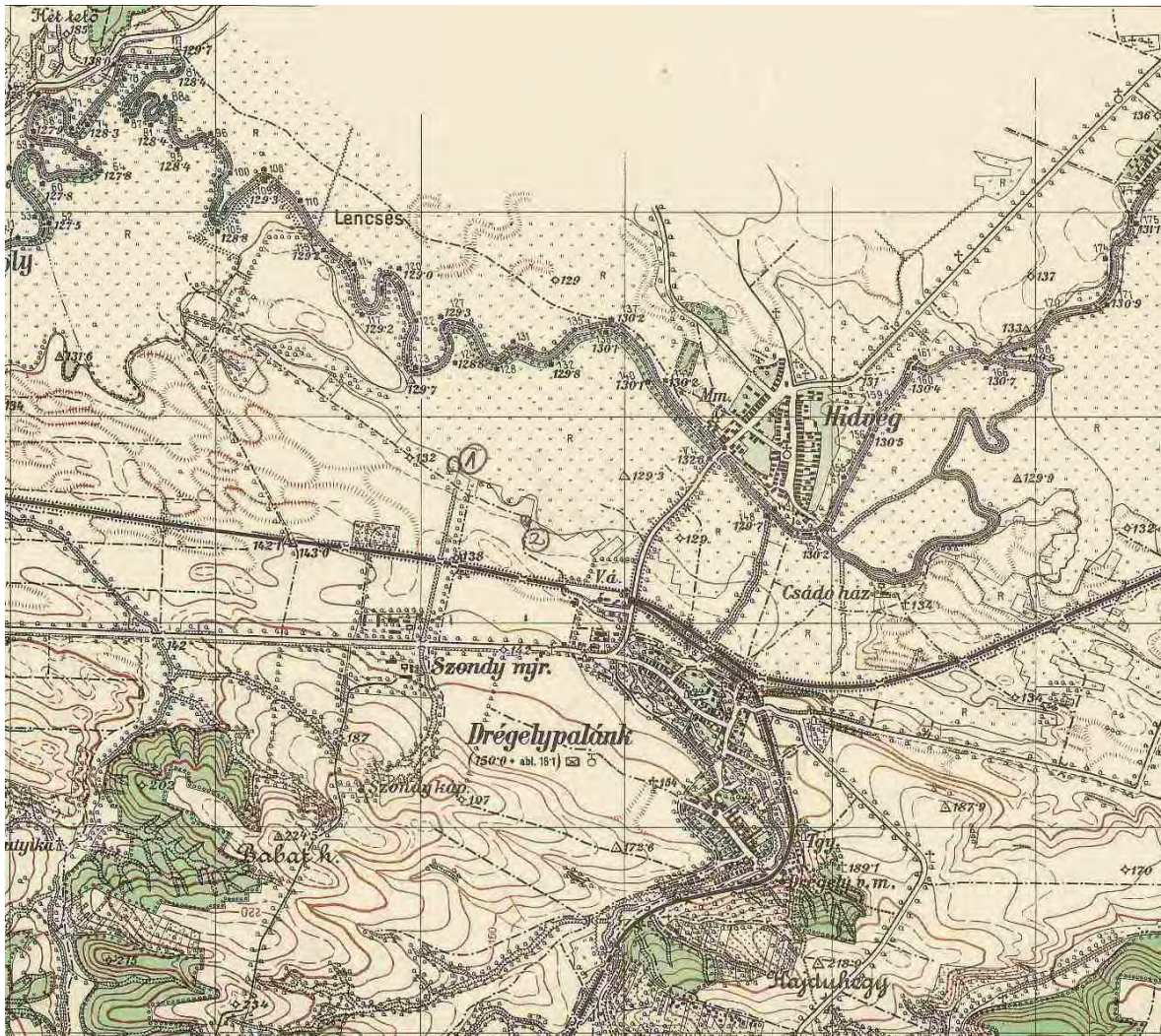
1. térképrészlet: A reambulálás során készült 1:25 000-es méretarányú térképszelvény részlete (4763/3-as szelvény, 1923-ban reambulálva, 1934-es kiadás, Magyar Kir. Állami Térképészet)
