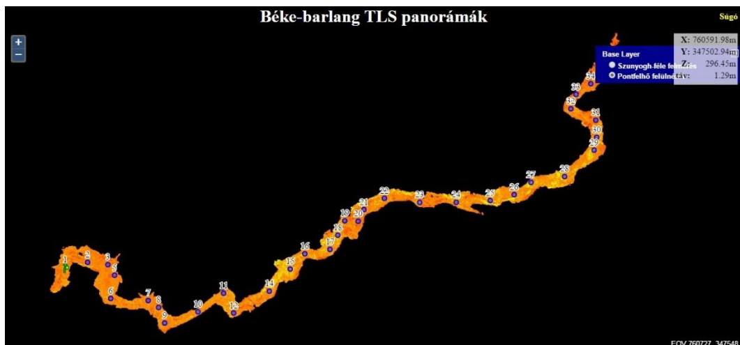
9. ábra: A Béke-barlang felmért részének pontfelhője felülnézetből
